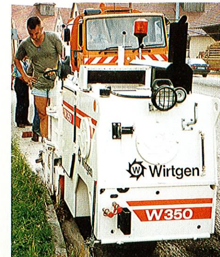
右ホイールを本体の中に入れて、右エッジぎりぎりを簡単に切削中
